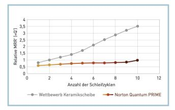
Spannlänge mit sehr geringem Schleifdruck wirtschaftlich durch eine Reduzierung der Schleifzeit und der Abrichtintervalle zu bearbeiten", erläutert Bernd Magiera. "Das Ergebnis: Die Norton-Quantum-Prime-Spezifikation reduzierte im Gegensatz zur bis dahin eingesetzten Schleiflösung die Schleifzeit um 50 Prozent. Gleichzeitig konnte die Scheibenstandzeit um 200 Prozent erhöht werden. Dadurch ergibt sich eine zusätzliche deutliche Reduzierung der Gesamtprozesskosten."
