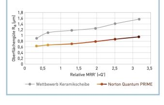
2 Verbesserte Geometriehaltigkeit: Beim Innenrundschleifen mit einem Norton-Quantum-Prime-Schleifwerkzeug bleibt die Werkstückqualität im Vergleich mit einem Wettbewerbs-Keramikprodukt aufgrund der verbesserten Formhaltigkeit konstant
